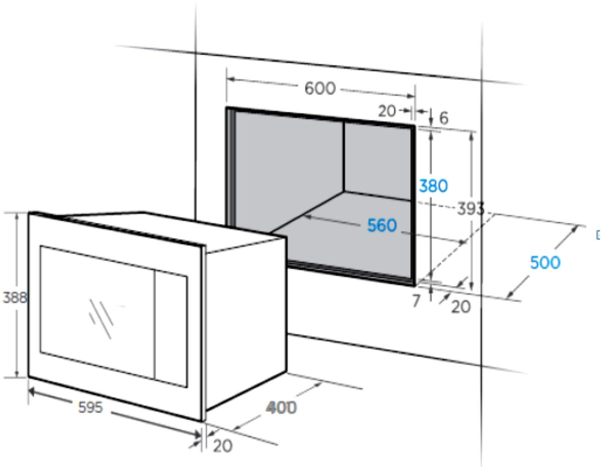
Задняя панель корпуса встраиваемой печи не должна быть закрыта задней стенкой кухонной мебели.
